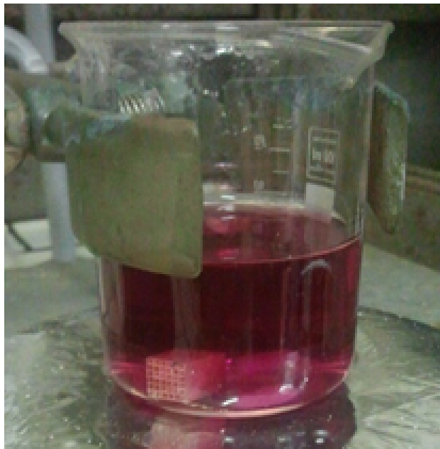
Figura 2.4: Fase di evaporazione dell'acqua per la sintesi diretta di \text{LaCoO}_3 su monolita
