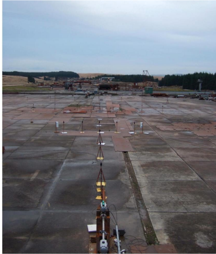
Figura 4.18. Fotografia del campo di rilascio, dell'orifizio e della strumentazione di misura (fonte: Advantica).
