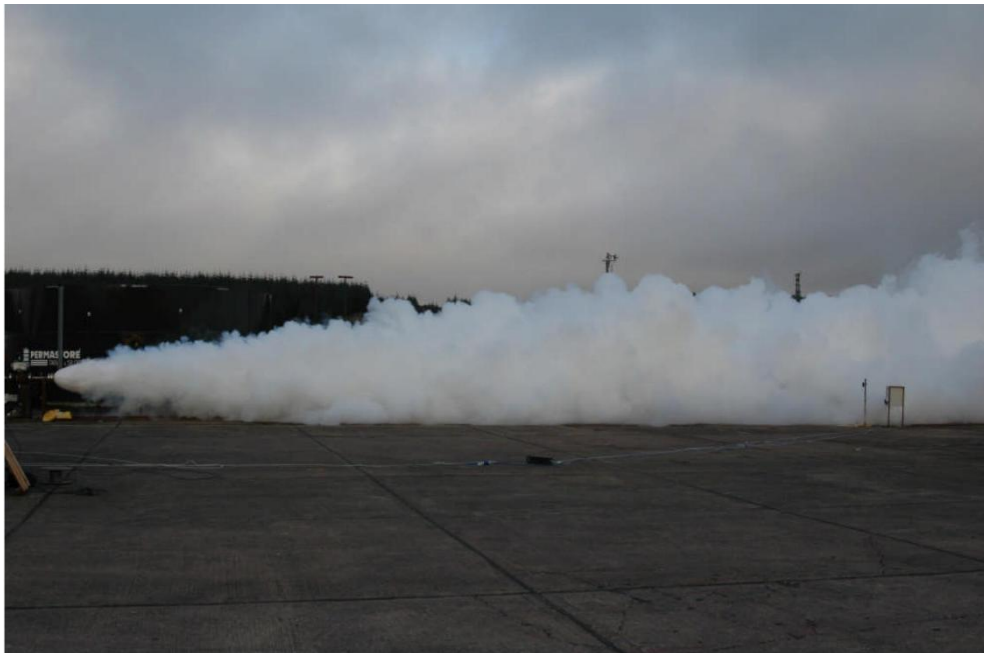
Figura 4.19. Rilascio di CO 2 attraverso l'orifizio da 1'' (fonte: Advantica).
