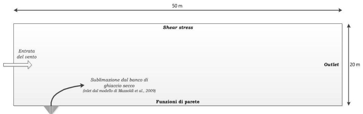
Figura 6.2. Geometria 2D con indicazione delle principali boundary conditions implementate.
