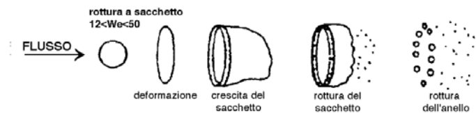
Figura 4.2. Regime di rottura "a sacchetto".
