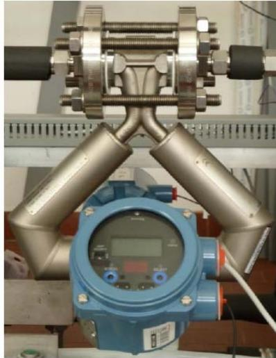
Figura 4.5: misuratore di portata massica ad effetto Coriolis. Fonte: Salvatore [63].
