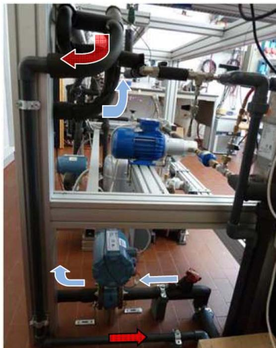
Figura 4.7: il circuito secondario dell'acqua fredda: il precondensatore. Fonte: Salvatore [63].
