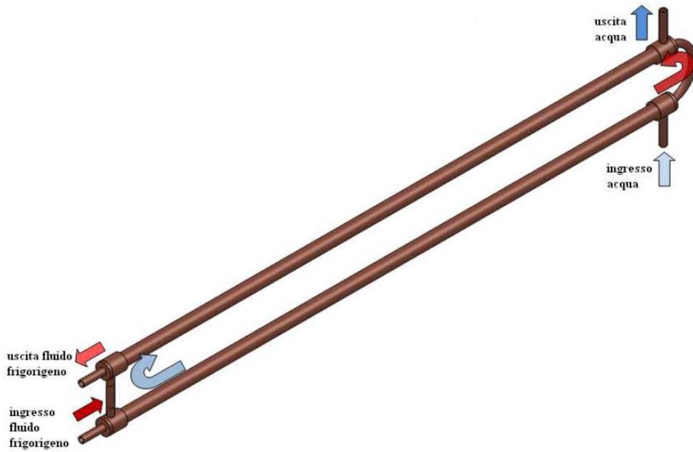
Figura 4.8: scambiatore di calore di tipo tubo in tubo. Fonte: Salvatore [63].
