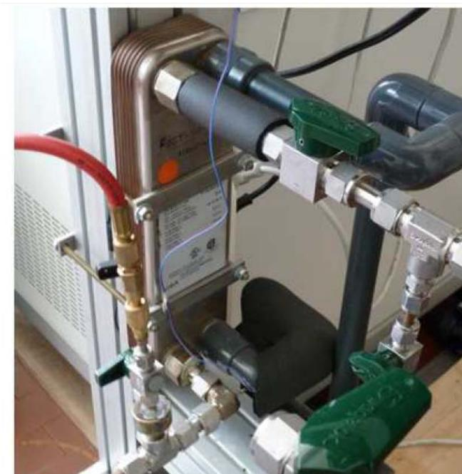
Figura 4.9: il circuito secondario dell'acqua fredda: il postcondensatore. Fonte: Salvatore [63].
