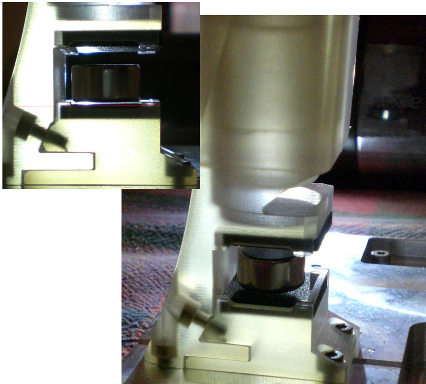
Fig. 8.4 Levitazione stabilizzata di un magnete di dimensioni \phi = 15mm , spessore 8mm al Neodimio. In questo caso la levitazione è completa con una ottima stabilità.
