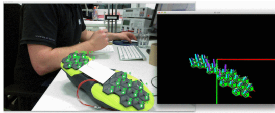
Figura 3.14: Inquadratura della telecamera e visualizzazione 3D assoluta della suola di una scarpa, dotata di un pezzo di pelle costituito da 23 moduli tattili. Sei dei moduli nel mezzo sono occlusi da un biglietto da visita. | Fig. da [5]
