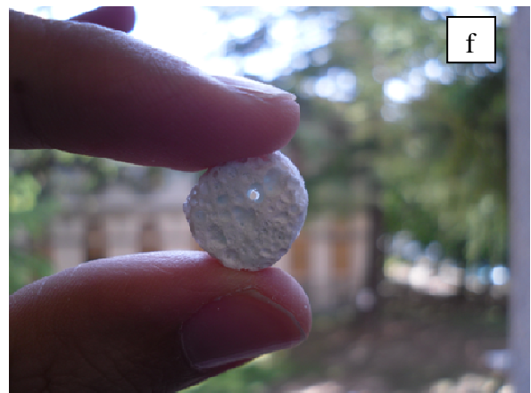
Figura 4.33-Immagine del campione Aker_5%bor_nano dopo reticolazione (a,d) e dopo ceramizzazione (b,c,e,f)
