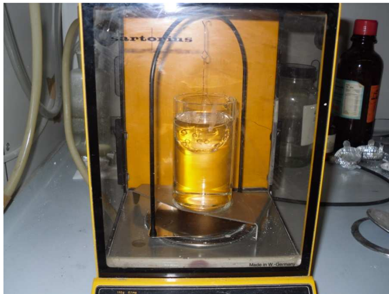
Figura 4.1- Misura densità con metodo di Archimede
