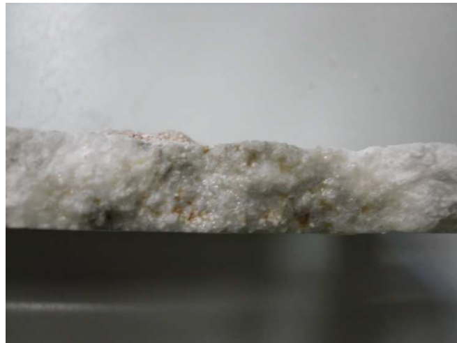
Figura 4.18- Refrattari con fase vetrosa infiltrata
