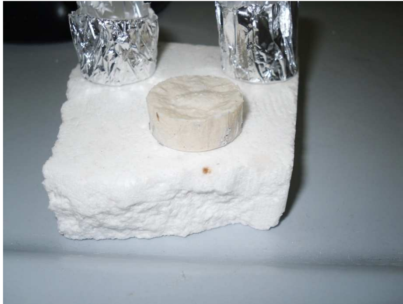
Figura 3.4- Campione 13-93_H62C dopo reticolazione
