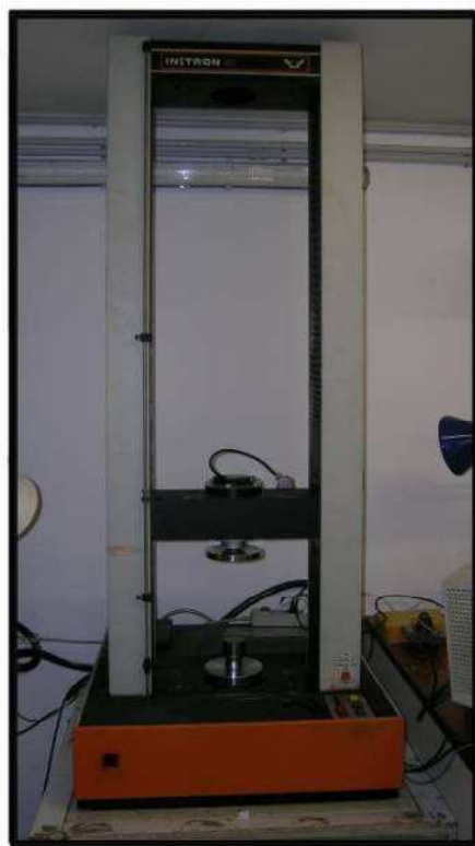
Figura 4.3- Macchina Instron 1121 per le prove meccaniche
