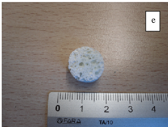
Figura 4.33-Immagine del campione Aker_5%bor_nano dopo reticolazione (a,d) e dopo ceramizzazione (b,c,e,f)
