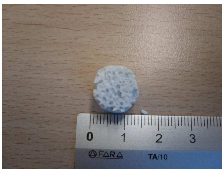
Figura 3.7- Campione Akermanite porosa dopo lappatura
