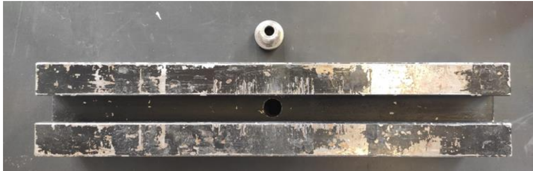
Figura 6.28: traversa inferiore e perno di centraggio forato
