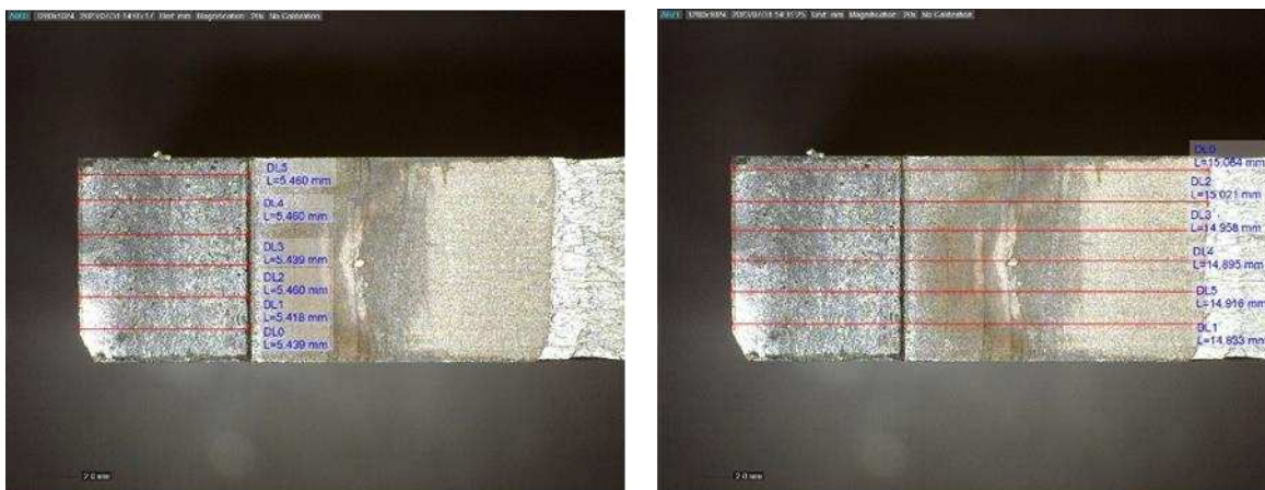
Figura 7.22: misure al DinoLite, lunghezza di cricca iniziale e finale
