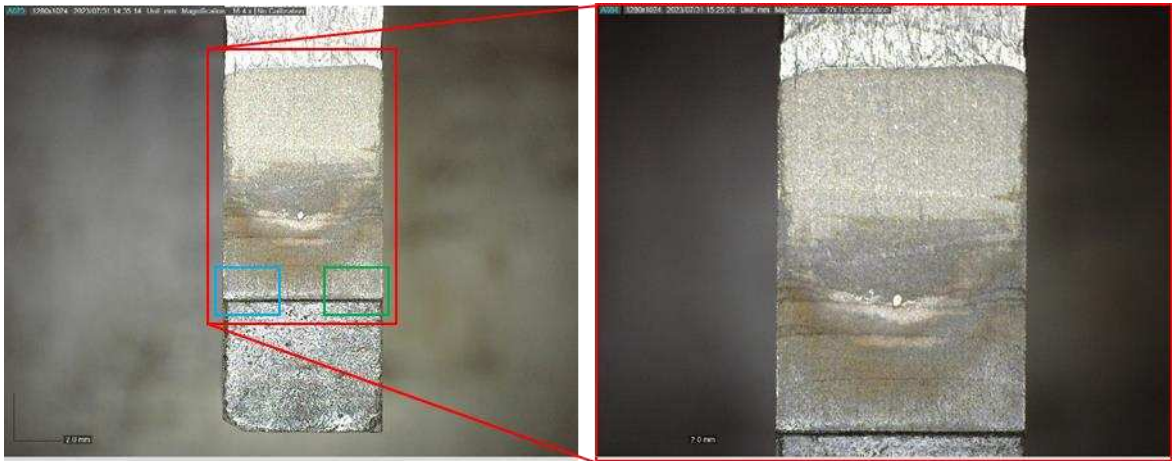
Figura 7.19: provino rotto (a), zoom sulla superficie di frattura (b)
