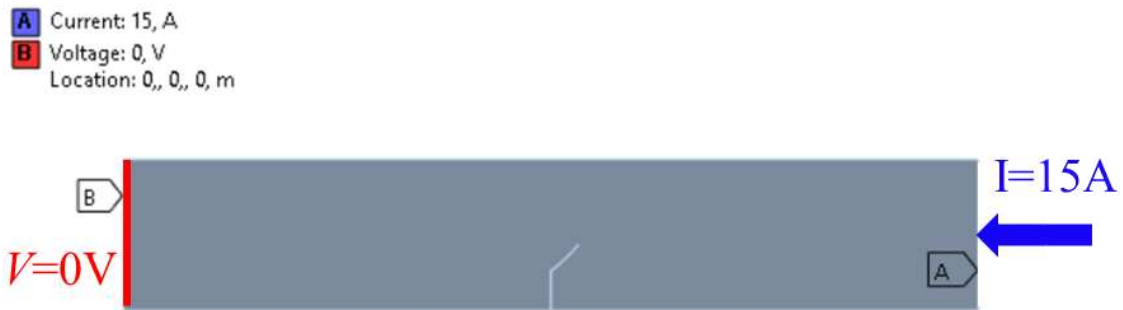
Figura 8.22: carichi e vincoli del modello FEM elettrico
