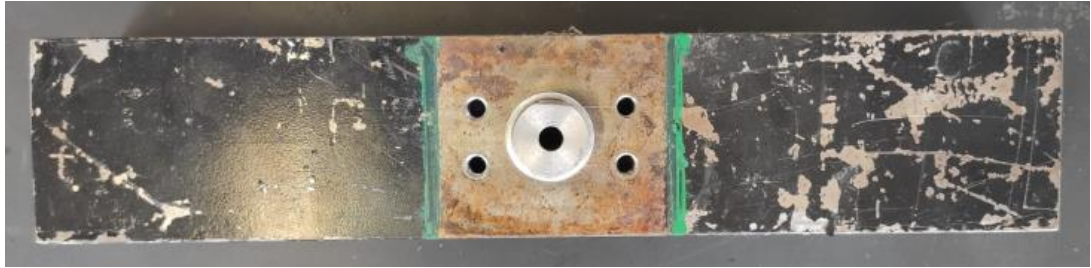
Figura 6.33: traversa superiore con perno di allineamento forato
