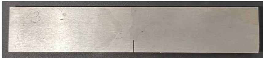
Figura 6.3: provino SENB HAZ17
