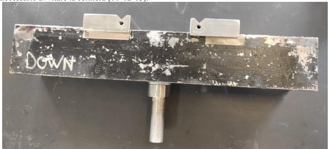
Figura 6.37: perno cilindrico per l'afferraggio in macchina
