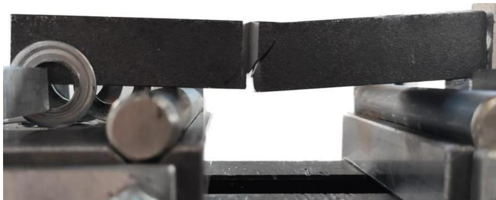
Figura 8.13: provino SENB rotto al termine della prova
