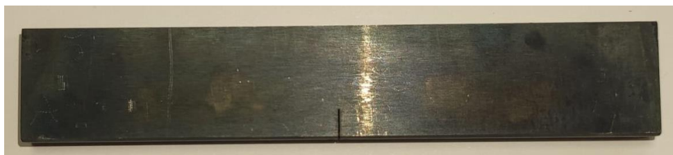
Figura 7.1: provino SENB AN05 lato A
