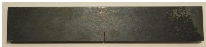
Figura 6.4: provino SENB AN05
