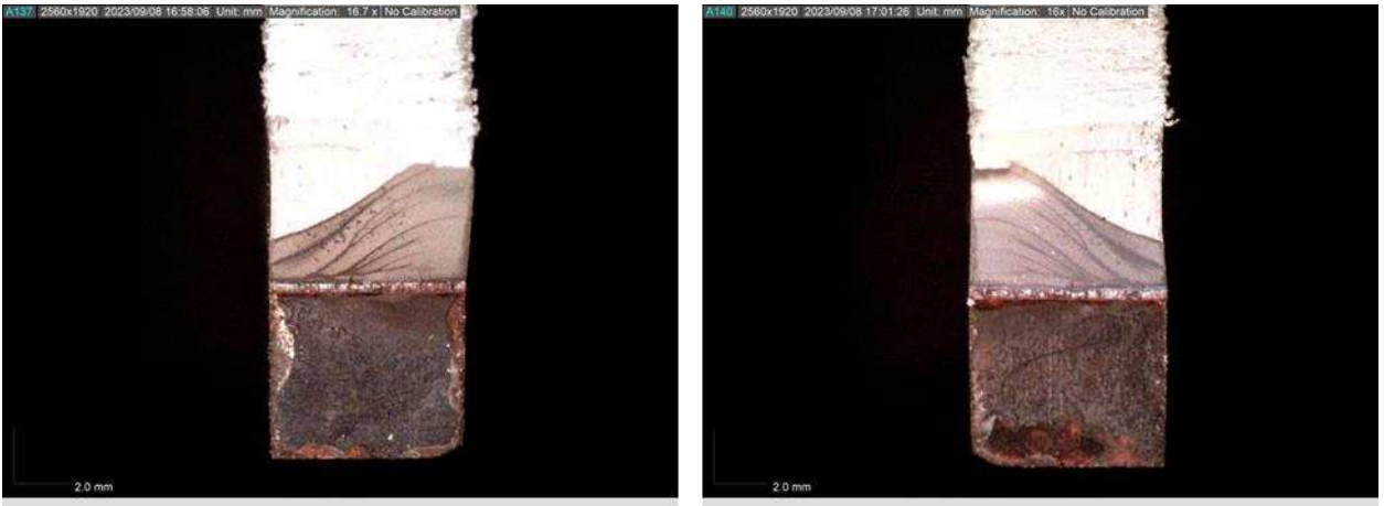
Figura 8.42: superficie di frattura, concio 2 (a), concio 1 (b)
