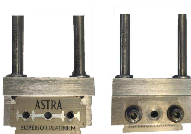
Figura 6.14: montaggio della lametta sul supporto
