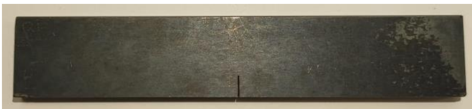
Figura 7.2: provino SENB AN05 lato B
