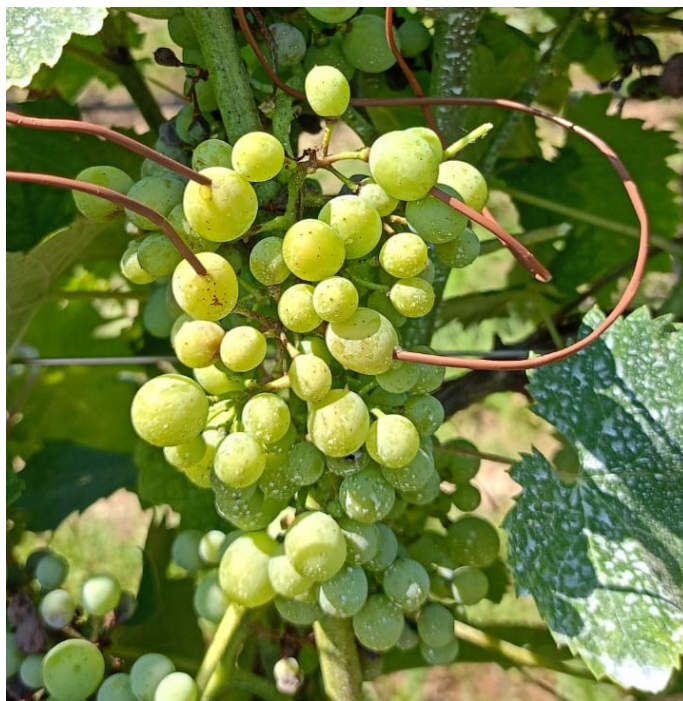
Figura 11 - Termocoppie applicate in maniera randomizzata agli acini per la rilevazione della temperatura delle bacche.
