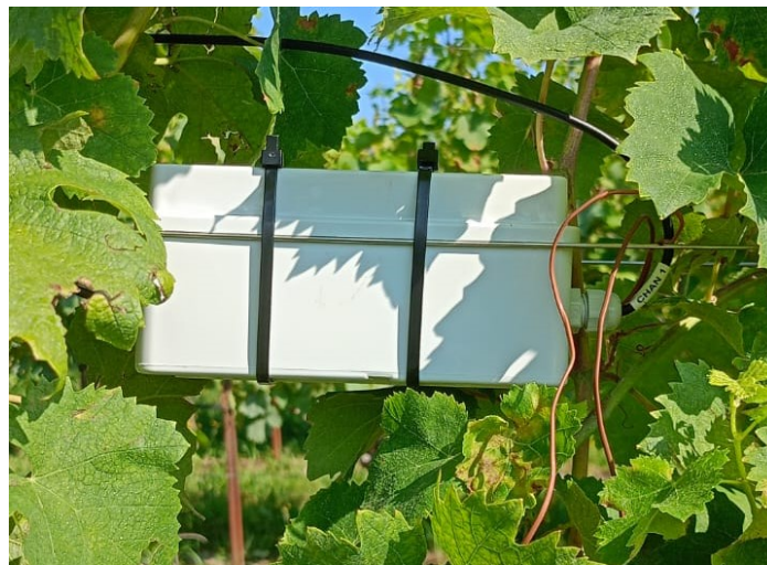
Figura 8 - Scatola impermeabile contenente i due datalogger fissata sulla chioma della vite.
