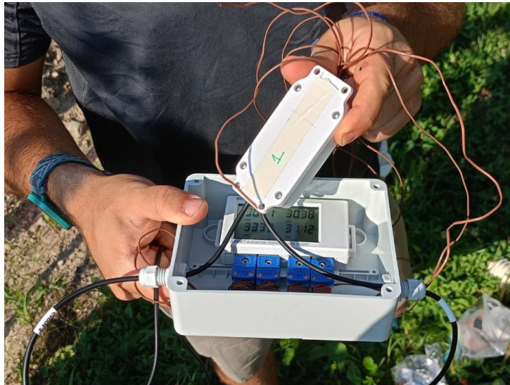
Figura 7 - Datalogger racchiusi nella scatola impermeabile.
