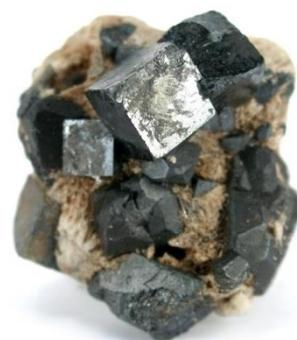
*Figura 1.1: Esempio di cristalli di perovskite s.s. ( $\text{CaTiO}_3$ )*
