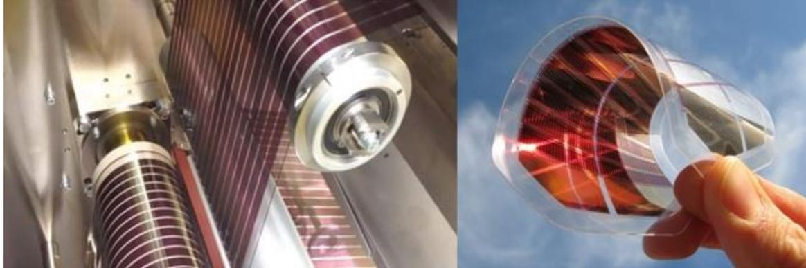
*Figura 2.12: Sulla sinistra, è riportata un'immagine di un processo roll to roll per la produzione di celle solari polimeriche; sulla destra, una cella polimerica flessa*
