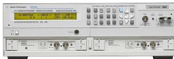
Figura 4.6: Pannello frontale dell'analizzatore di parametri
