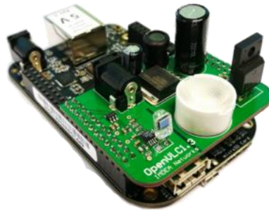
Figura 3.2 Apparato OpenVLC 1.3 completo
