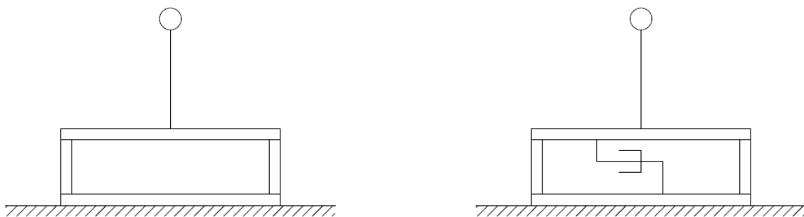
Figura 38 Rappresentazione schematizzata di una struttura con e senza smorzatore
