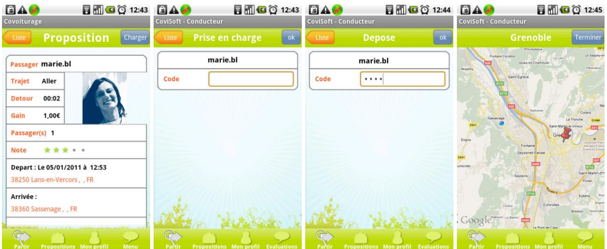
Figura 3.5: istantanee dell'applicazione COVISOFT per Android nella modalità “conducente”. Fase di ricezione richiesta di covetturaggio, accettazione e inserimento codice passeggero.
