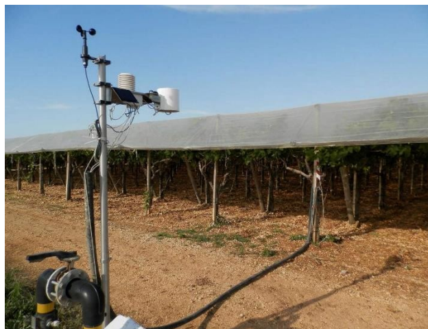
Foto 2.4: Strumentazione per il monitoraggio di dati utili all'irrigazione smart. (Fonte foto: www.terraevita.edagricole.it )
