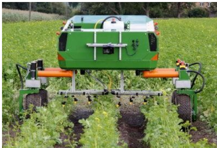
Figura 2.3: Robot impiegato nella difesa delle colture. (Fonte foto: www.whatsnewinfarming.co.uk )
