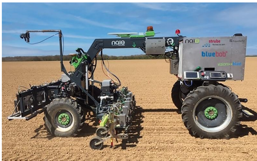
Fig. 2.2: Robot (BlueBob) impegnato in operazioni di semina. (Fonte foto: www.naio-technologies.com )
