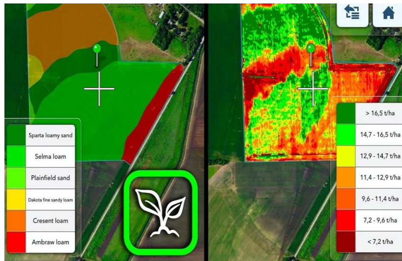
Figura 2.6: Tipica mappa di resa creata da dispositivi integrati alla macchina di raccolta (Fonte foto: www.tractorum.it ).
