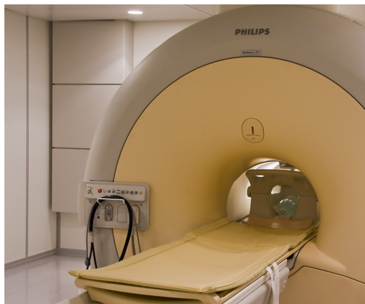
Figura (3.1). Strumentazione di risonanza magnetica Philips Achieva 1.5T A-series, disponibile presso Euganea Medica in fase di calibrazione. È possibile vedere il contenitore di acqua e sali usato come phantom in quest'operazione.
