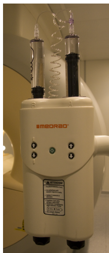
Figura (3.3). Pompa d'infusione MEDRAD Spectris Solaris EP MR Injection System utilizzata per iniettare l'agente di contrasto nei pazienti durante l'esame.
