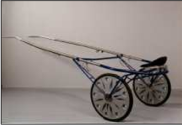
Figura 1.7: Ghighetta in acciaio, utilizzata per gli allenamenti dei cavalli in preparazione alle corse che si svolgono invece con il sulky ( www.sulkyshop.co.nz/sulky.shtml ).
