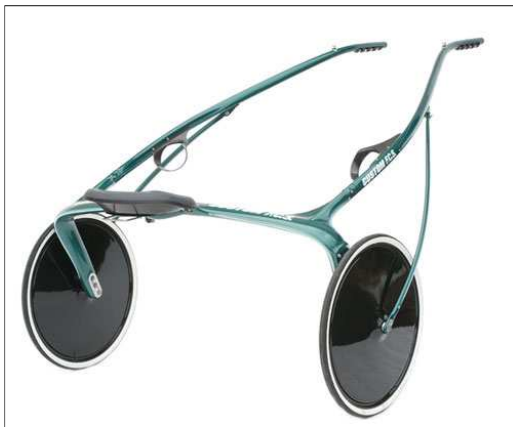
Figura 1.8: Sulky modello CUSTOM F.C.S. (Full Carbon Sulky), interamente in carbonio, utilizzato per le gare e per le prove di qualifica ( www.customsulky.xetnet.com ).
