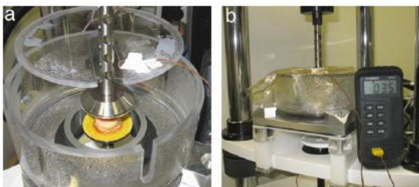
**Figura 3.2. Apparecchiatura sperimentale, dove si vede in (a) il campione all'interno della camera speciale e in (b) dopo aver sigillato il tutto con la plastica per ricreare le condizioni fisiologiche**
