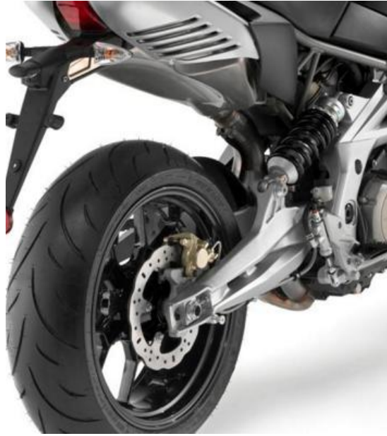
Figura 3: Aprilia SMV 750 Dorsoduro con applicazione del meccanismo sospensivo “Cantilever” laterale
