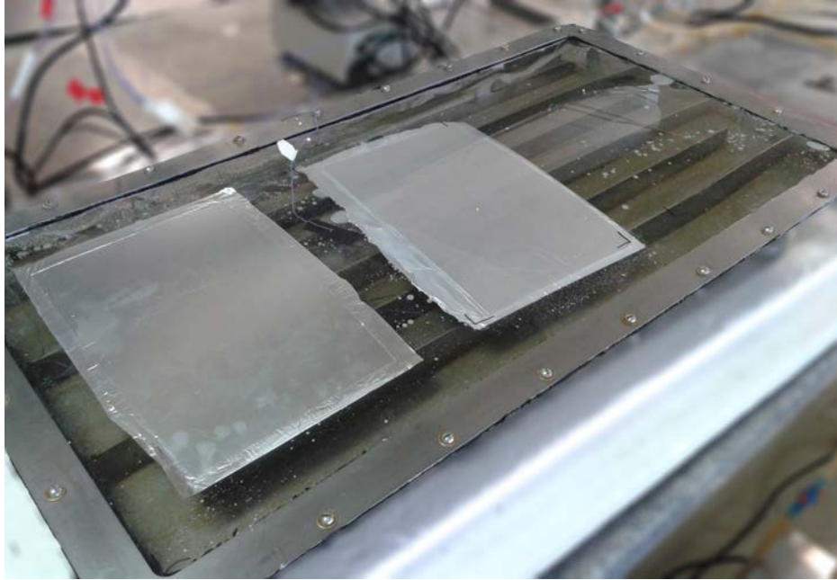
Figura 4.4: Il Refractance Window con il Mylar schermato con l'alluminio (l'alluminio è incollato sopra al Mylar a sinistra e sotto al Mylar a destra)
