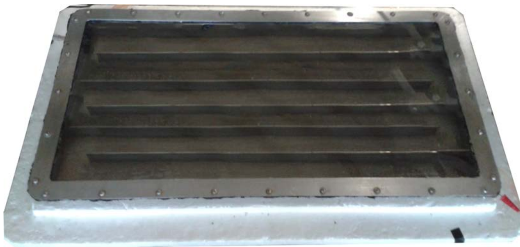
Figura 3.2: Fotografia del modello di RW creato in laboratorio
