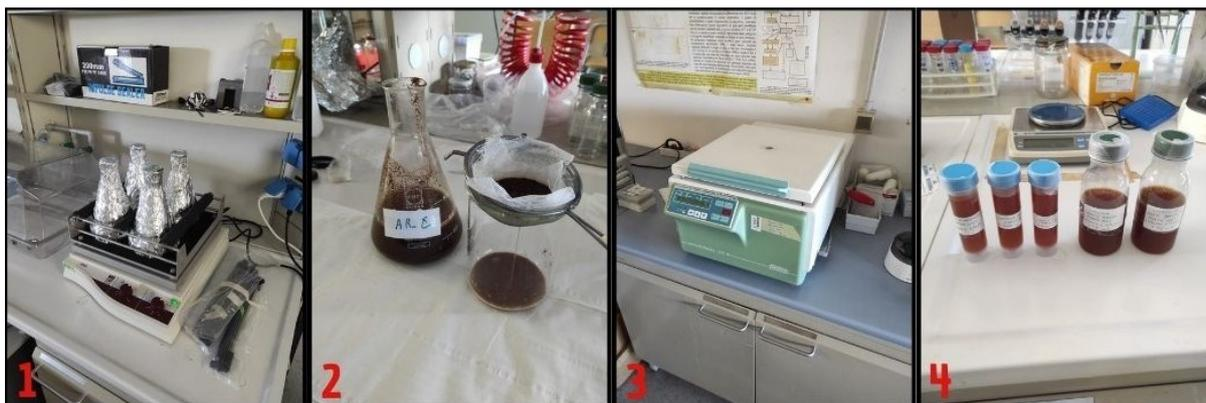
Figura 2: Varie fasi del processo di estrazione acquosa condotto in laboratorio; in ordine, da sinistra verso destra, sono mostrate la macerazione in beuta posta su agitatore (1), la filtrazione (2), la centrifugazione (3) e la conservazione degli estratti puri (4).
