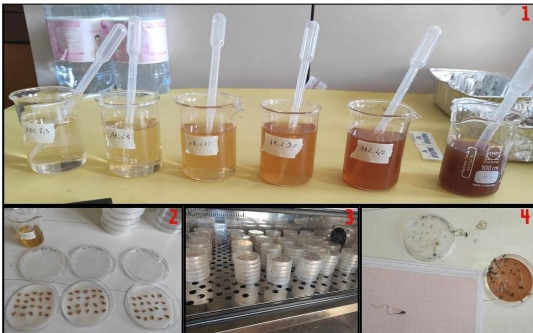
Figura 4: Diluizioni dell'estratto acquoso di corteccia di abete rosso, da sinistra verso destra, di 2.5, 5, 10, 20, 40, 100% v/v (1), 3 repliche del frumento trattato con AR\_C 10% v/v (2), piastre Petri in cella di germinazione (3) e dettaglio del rilievo sulla lunghezza radicale e del fusto con carta millimetrata (4).
