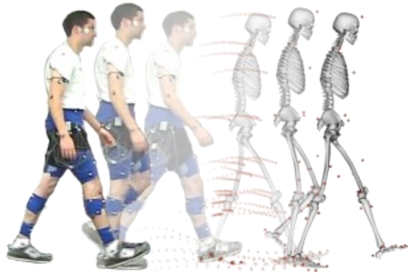
Fig. 20: Rappresentazione di marker sperimentali e marker virtuali. Grazie alla cinematica inversa, i marker presenti nel soggetto durante la prova sperimentale vengono riprodotti fedelmente nei marker virtuali del modello [34].
