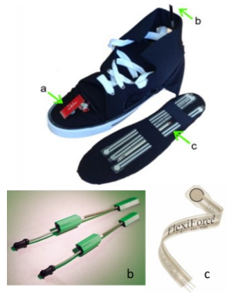
Fig. 5: Applicazione di elettrogoniometri e sensori di pressione in una scarpa strumentata [5].
