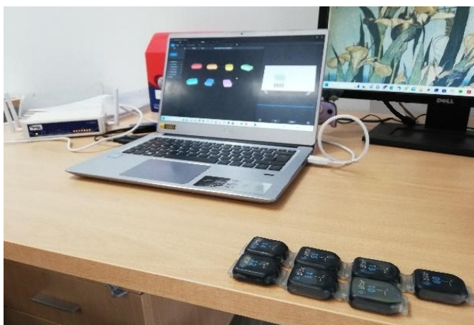
Fig. 29: Posizionamento delle IMU per la calibrazione.
