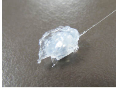
Figura 3.17: Rivestimento in silicone della metallizzazione
