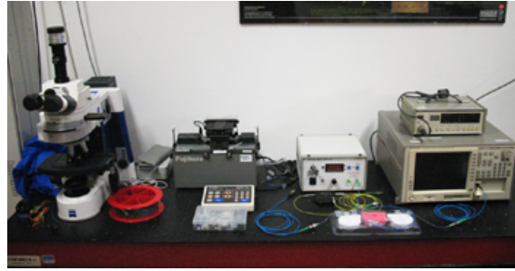
Figura 3.7: Foto del banco per la visualizzazione di interferenze a banda larga
