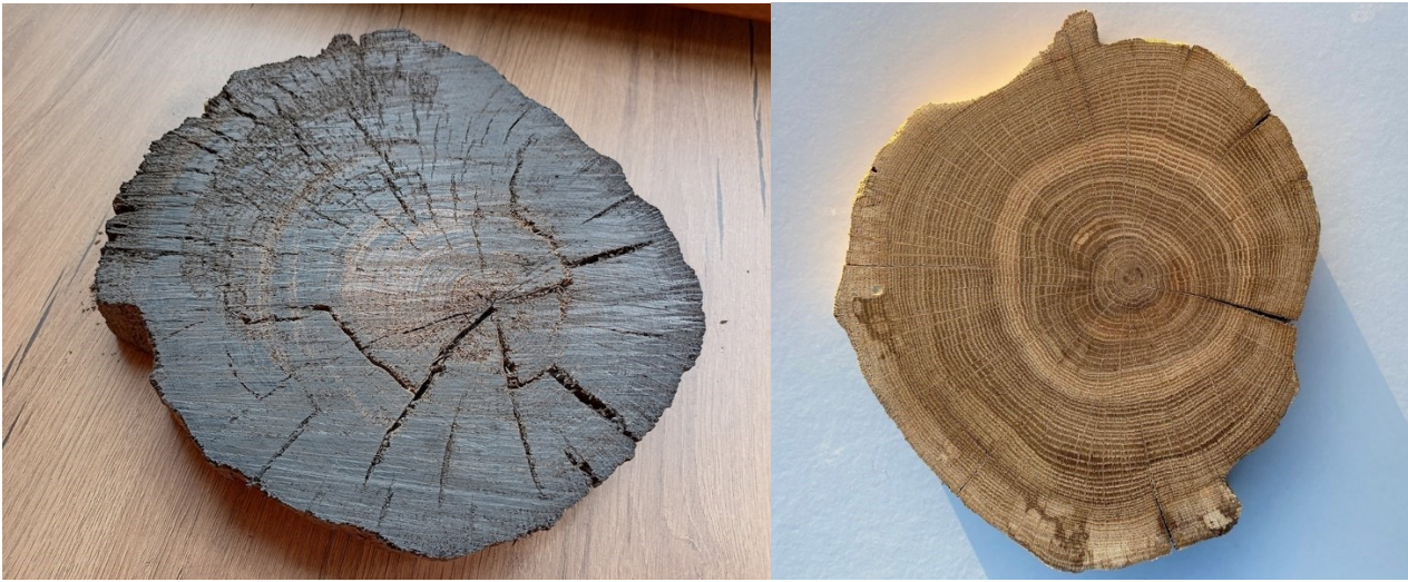
Figura 2.16 a. Rotella di legno di quercia subfossile. Figura 2.16 b. Rotella di legno di quercia recente.
