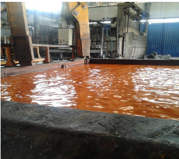
Figura 4.7 Vasca con spegnimento in acquaquench
