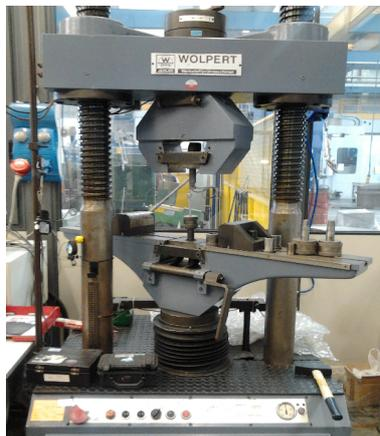
*Figura 9.5 Macchina di trazione Wolpert*
