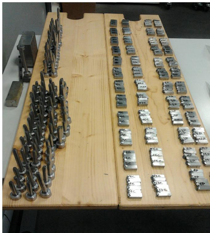
*Figura 4.12 I provini delle prove meccaniche: sulla destra quelli relativi alla prova di trazione, mentre sulla sinistra quelli della prova di resilienza*
