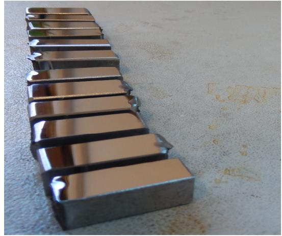
*Figura 4.14 Provini lucidati per l'osservazione con microscopio*
