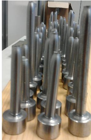
*Figura 9.4 Provini di trazione con testa semplice utilizzati*
