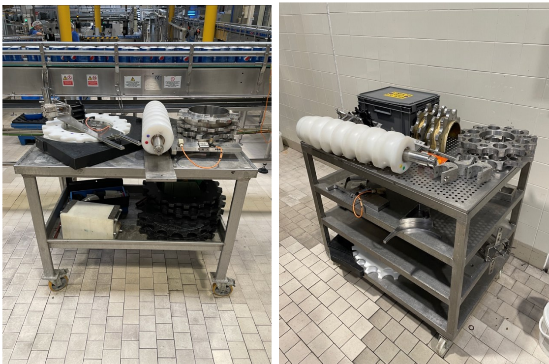
Fig. 9.8.1 (a sinistra) e 9.8.2 (a destra) – Carrelli porta pezzi utilizzati per il cambio formato della riempitrice (carrello di sinistra) e dell’aggraffatrice (carrello di destra).
