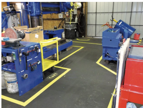
Fig. 3.3 – Rappresentazione dei marcatori a pavimento (a nastro) all'interno di un'area di lavoro
