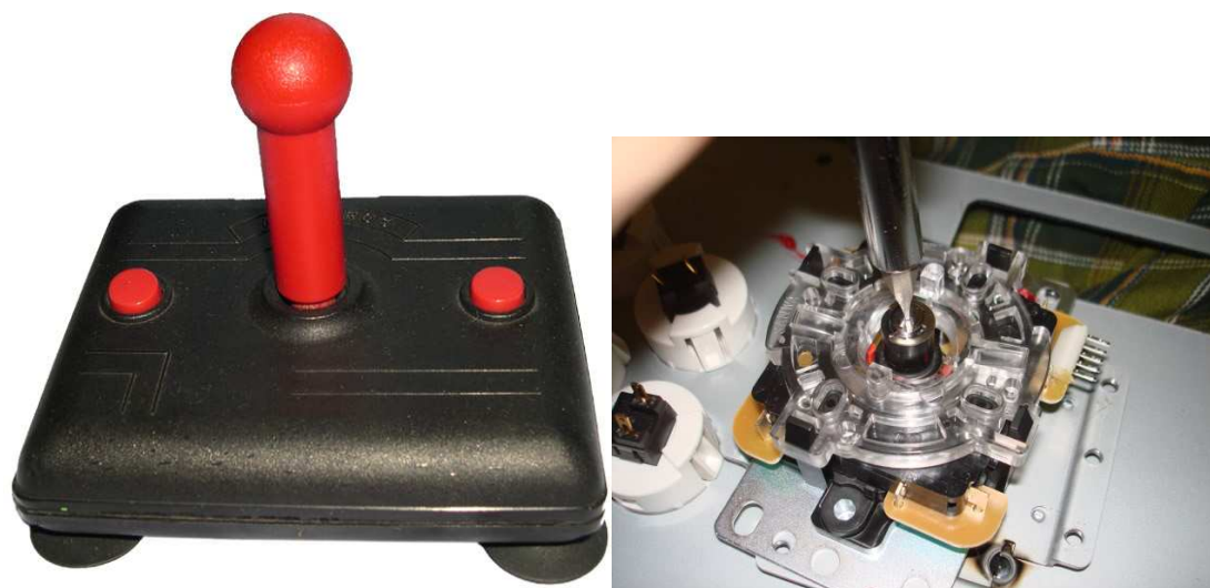
Figura 1.8: Il joystick per Commodore64, modello albatros, e una vista interna di un modello simile: quando l’asta raggiunge il fine corsa attiva i microswitch, indicando la direzione desiderata (fonte [1]).
