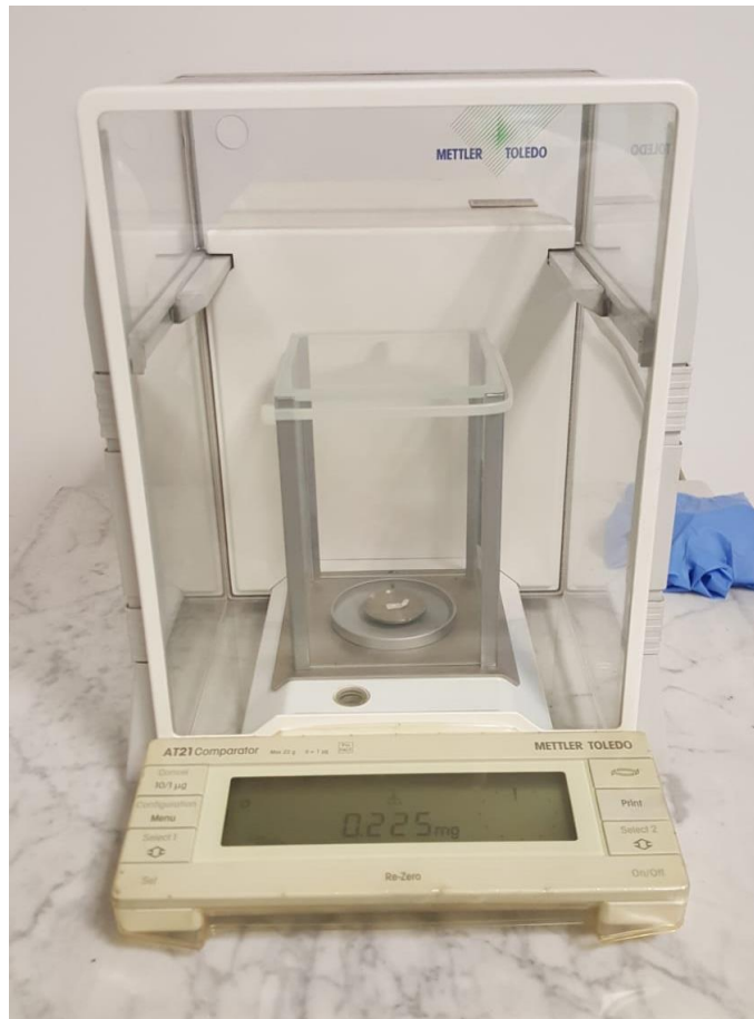
Fig. 3.8 – La bilancia a tre cifre decimali utilizzata per pesare gli standard.
