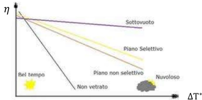
Figura 3.10 Curva di efficienza di diverse tipologie di collettori a confronto
