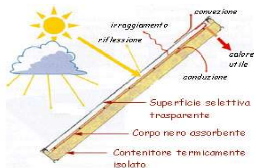
Figura 3.3 Flussi energetici in un collettore piano
