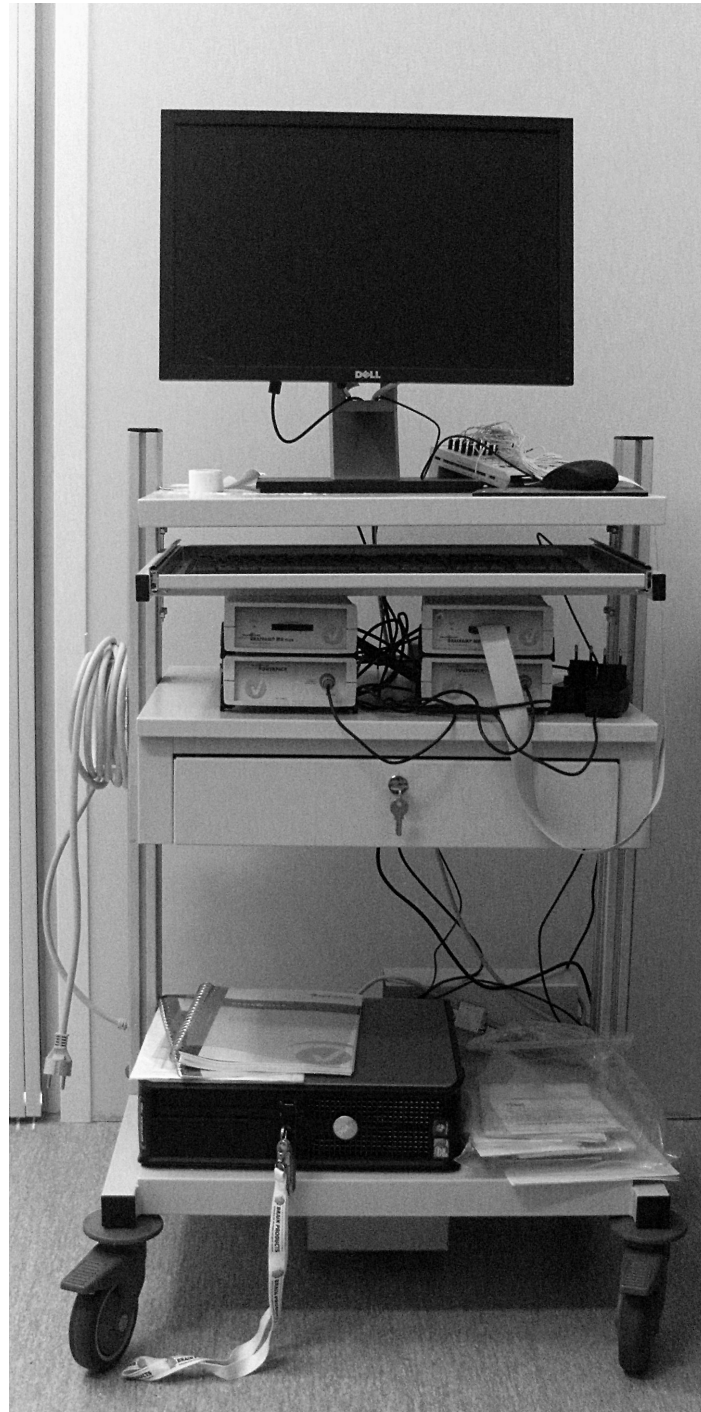
Figura 1.12: Esempio di apparecchiatura elettroencefalografica PC-based. Si possono individuare – dall’alto – il monitor, la testina EEG cui è collegata una cuffia di elettrodi (dietro al mouse), la tastiera, due amplificatori BrainAmp sopra ai due rispettivi Powerpack di alimentazione (prodotti dalla EMS), e il case del PC. Foto scattata alla strumentazione dell’IRCCS San Camillo.
