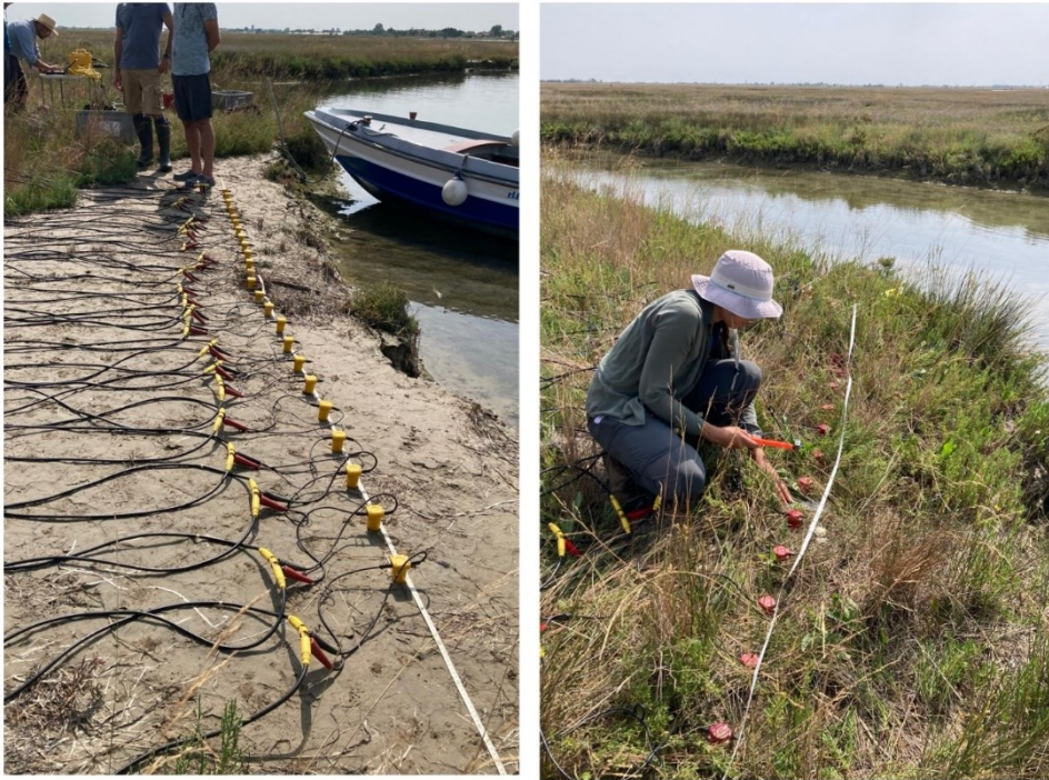
Figura 10: acquisizione dei dati in barena, nell'immagine a sinistra si può notare lo stendimento su suolo nudo. Nell'immagine di destra, si può notare lo stendimento su suolo vegetato e l'uso del micro-martello strumentato (Carrera, 2023).
