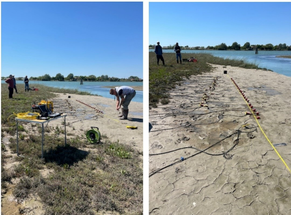
Figura 11: acquisizione dei dati in barena, nell'immagine a sinistra si può notare l'intero stendimento e il sismografo utilizzato. L'immagine di destra è un ingrandimento dell'immagine precedente (Boaga, 2024)
