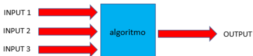
Figura 9. Schema di funzionamento di un algoritmo di machine learning. In ingresso vengono forniti dei dati di input, i quali vengono elaborati da un algoritmo di machine learning e viene prodotto in uscita un output.
