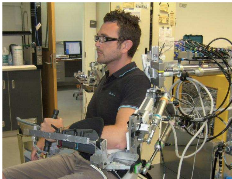
Figura 1.2: Il Pnew-WREX , un dispositivo robotico - esoscheletro - guidato da attuatori pneumatici.
