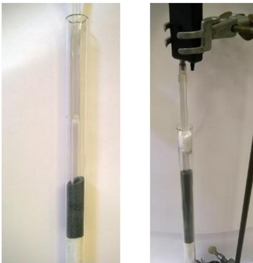
**Fig. 4. 14.** Configurazione del termometro ad aria inserito nel tubo in quarzo con carburo di silicio. In fase di riempimento (sinistra) e a riempimento completato (destra)
