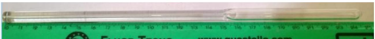
**Fig. 4. 10.** *Il prototipo di termometro realizzato in vetro boro silicato.*
