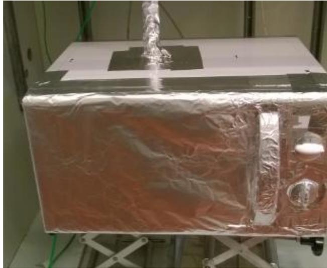
**Fig. 4. 6.** *Forno a microonde provvisto di copertura in alluminio per l'isolamento elettromagnetico.*
