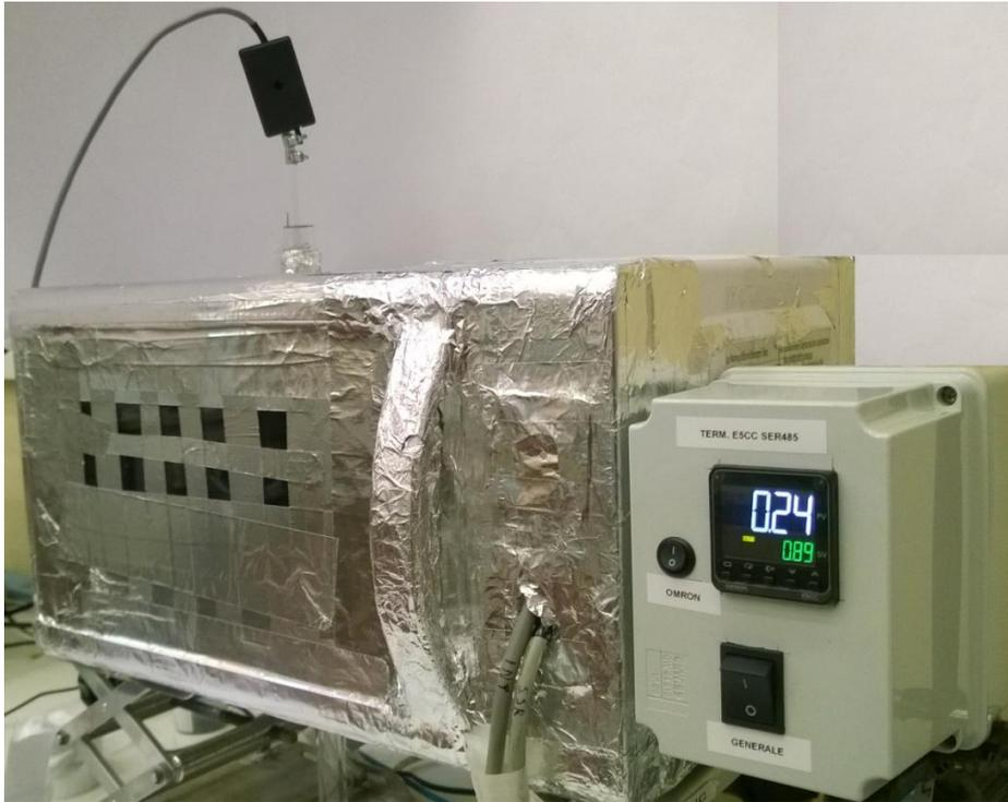
**Fig. 6. 8.** *Apparecchiatura completa di sistema di regolazione della temperatura.*
