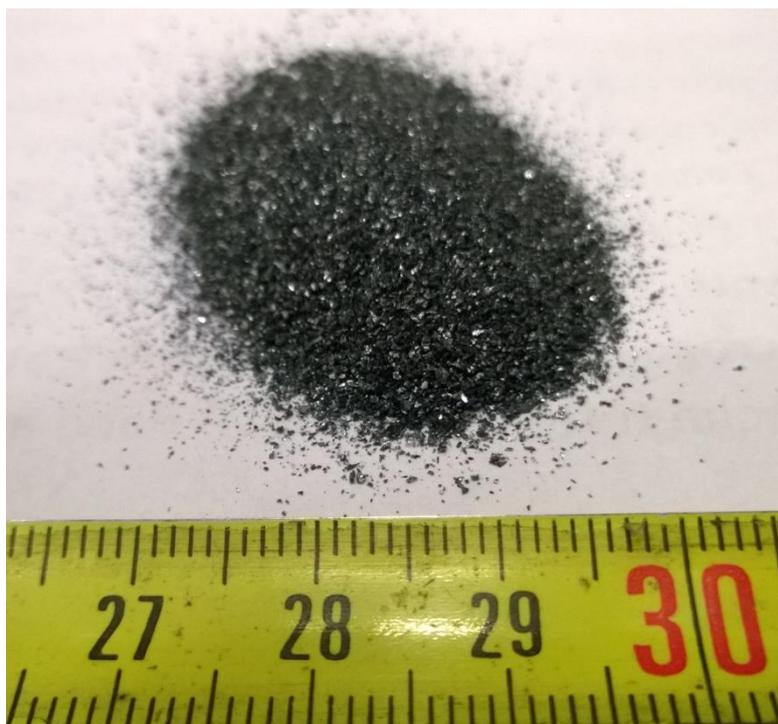
**Fig. 4. 3.** *Carburo di silicio (SiC), utilizzato come mezzo per lo scambio termico*
