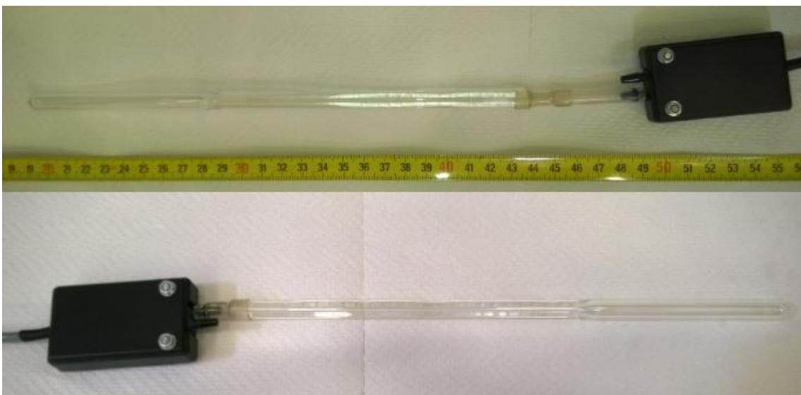
**Fig. 4. 13.** Configurazione del raccordo tra trasduttore di pressione e termometro ad aria nei casi limite analizzati
