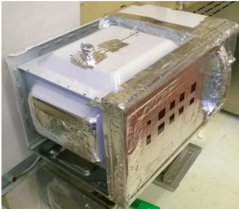
**Fig. 4. 7.** *Forno dopo ulteriore operazione di semplificazione della struttura per l'isolamento elettromagnetico*
