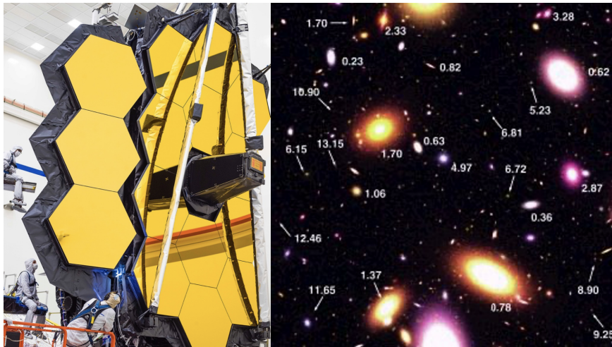
Figura 33. Sinistra: Nel test finale di JWST è stato lanciato il comando per l'espansione completa dello specchio da 6.5 metri, esattamente come accadrà un domani nello spazio. Destra: Simulazione di un campo profondo che JWST potrà osservare con indicati i redshift per oggetti selezionati. JWST è in grado di rilevare circa 100 oggetti a z > 5 in una piccola frazione ( < 1\% ) del campo visivo della camera.
