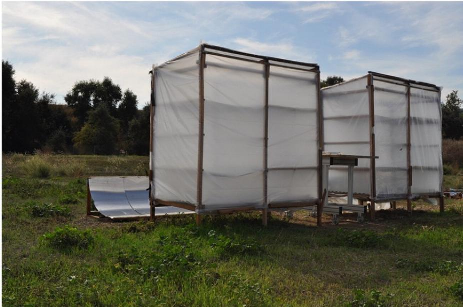
Il concentratore è composto da un telaio ad L di legno con fissato un foglio pulito di alluminio concavo con riflettanza 0.8. La superficie di riflessione in questo caso era  $1.71 \text{ m}^2$  ( $1.88 \text{ m} \times 0.91 \text{ m}$ ) [3].
