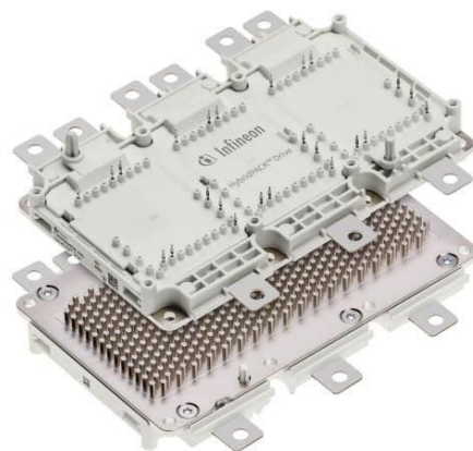
Fig. 2.5 - Aspetto esteriore dell'IGBT sixpack. Si noti la struttura con alette "pin fin" per lo smaltimento della potenza dissipata sotto forma di calore
