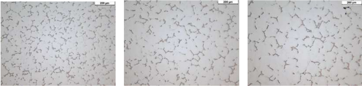
Figura 12: Micrografie OM a cuore a più alti ingrandimenti della lega A201 as-cast, con i provini Dallara (da sinistra a destra 4-A-1, 10-A-1, 20-A-1)
