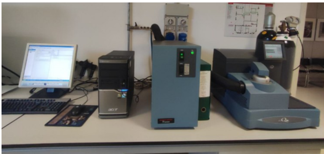
Figura 2.10 Configurazione TA Instrumet Q200 DSC
