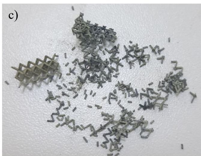
Figura 3.23 Rottura dei campioni trattati termicamente: a) GTS 2_HT; b) HTS_HT; c) GTS 1_HT
