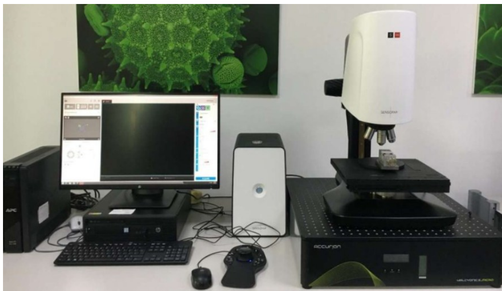
Figura 2.11 Apparato strumentale del profilometro Sensofar Metrology™ S Neox 3D optical profiler
