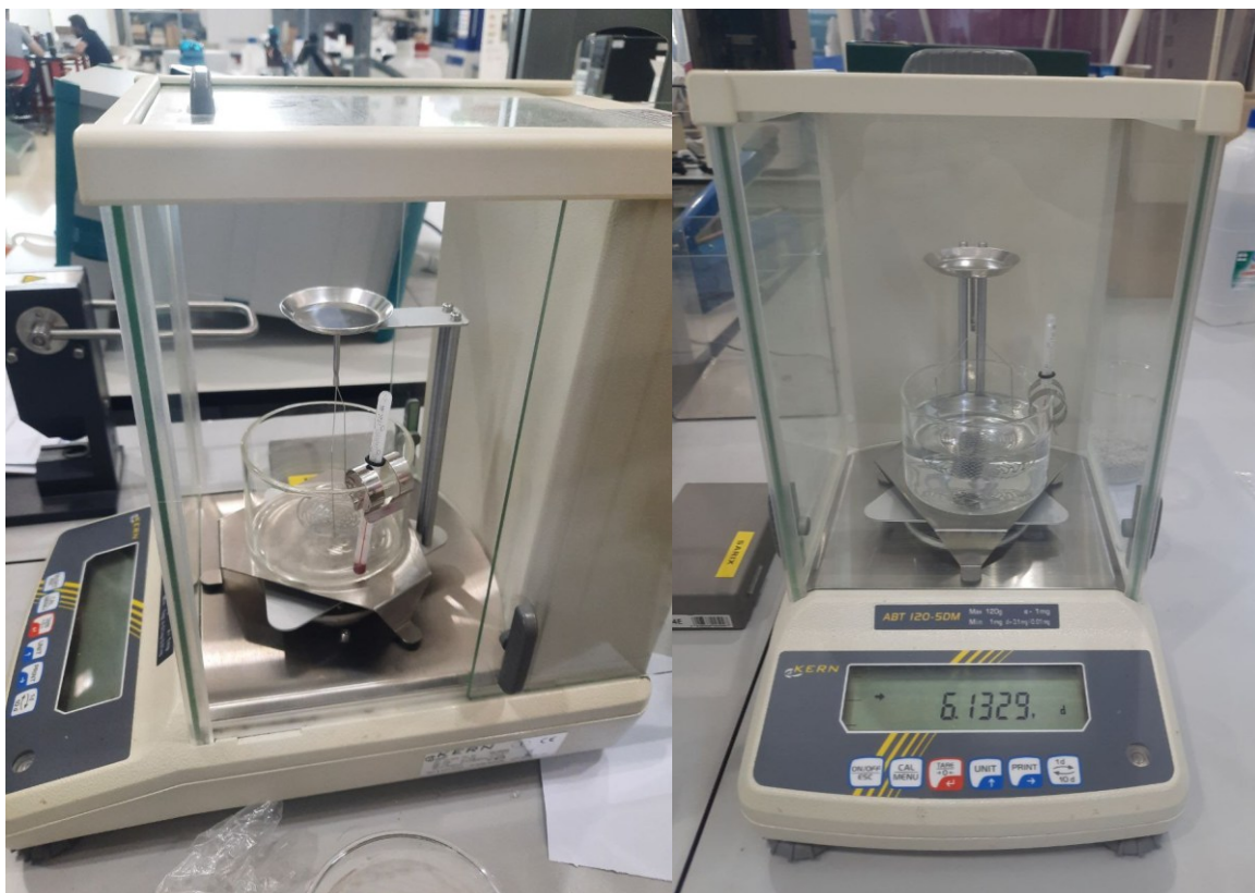
Figura 2.14 Apparato sperimentale per la misura della densità
