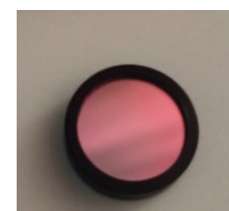
Figura 25 filtro passa banda
