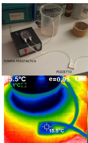
Figura 29 set up sperimentale per l'acquisizione degli spettri in continuo. Sotto, foto con termocamera del pozzetto termostato
