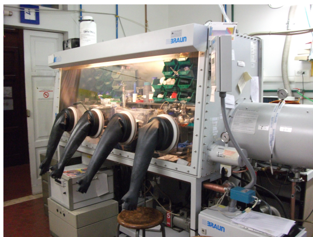
Figura 4.2: Fotografia del dry box utilizzato per compiere le operazioni in atmosfera inerte. All'interno di questo è presente un'atmosfera di Argon, mentre ossigeno ed acqua vengono eliminati tramite appositi filtri chimici ed i loro livelli sono costantemente monitorati. Si possono introdurre od estrarre i materiali dal dry box attraverso le due precamere visibili sulla destra, tramite un'apposita procedura che alterna lo svuotamento (tramite pompa da vuoto rotativa) della precamera, al suo riempimento col gas inerte contenuto nel box. Il processo va ripetuto per almeno tre volte, rispettando i tempi prescritti ed in tal modo è possibile introdurre materiali all'interno del dry box senza contaminarne l'atmosfera. All'interno del box si opera grazie ai quattro guantoni visibili sulla finestra attraverso la quale si può vedere l'interno dell'ambiente.
