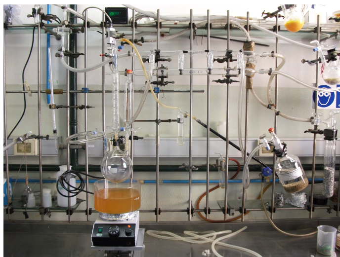
Figura 4.5: Fotografia dell'apparato montato in atmosfera inerte per la sintesi del \delta -[MgCl 2 ] n , pronto per la canulazione del 1-clorobutano. La bottiglia va fissata inclinata ad una distanza sufficiente per poter inserire agevolmente la canula nel setto della bottiglia e nel gocciolatore. Sul retro è visibile anche la trappola per lo sfiato, collegata tramite un tubo di gomma al rubinetto sulla sommità del ricadere a bolle.
