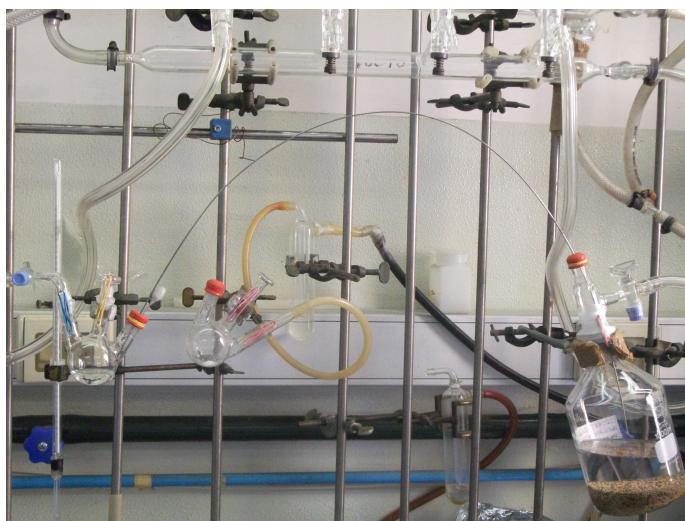
Figura 4.6: Esempio di canulazione di un liquido dalla bottiglia ad un pallone. Si possono notare i setti rossi, la canula che collega i due contenitori e l'ago (con il puntale ricoperto di parafilm) applicato per lo sfiato del gas.
