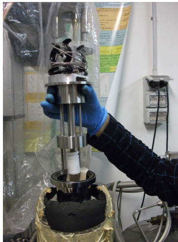
Figura 3.32: Inserimento della cella per le misure ad alta frequenza all'interno del termostato per il controllo della temperatura del campione.
