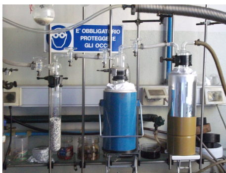
Figura 4.4: Fotografia delle trappole poste sulla linea di azoto per seccare completamente il gas in entrata. Le prime due sono inserite in altrettanti dewar contenenti azoto liquido in modo da far condensare sulle pareti della trappola l'umidità eventualmente presente nel gas. Per lo stesso scopo, la seconda e la terza trappola contengono al loro interno anche dei setacci molecolari.
