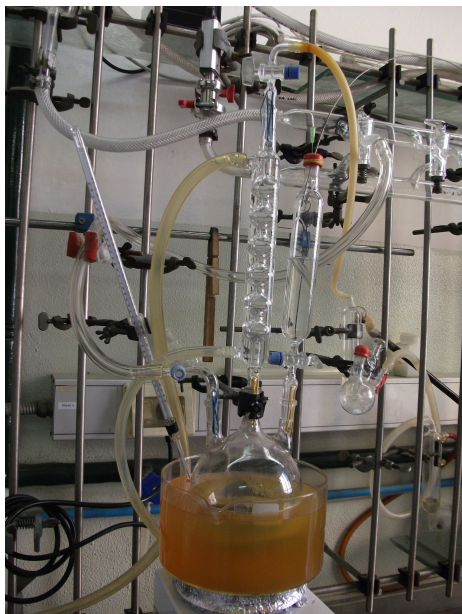
Figura 4.7: Procedura di canulazione del 1-clorobutano nel gocciolatore dell'apparato, eseguita secondo la procedura descritta a pagina 111.
