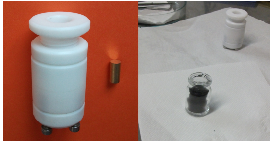
Figura 3.29: Metodi adottati per l'esecuzione della calibrazione della sonda coassiale in cortocircuito: a sinistra un cilindro d'oro la cui superficie a contatto con la sonda è stata lappata, a destra un contenitore con polvere micrometrica di grafite.
