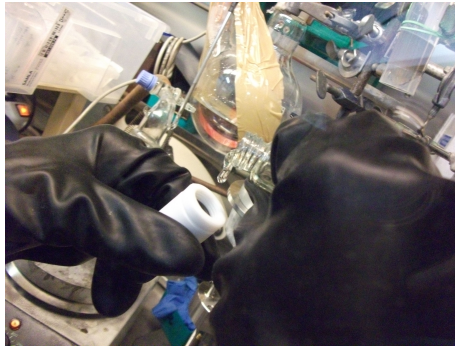
Figura 3.31: Operazione di caricamento del bicchierino di teflon all'interno del dry-box con un campione (PEG400 con \delta\text{MgCl}_2 ).
