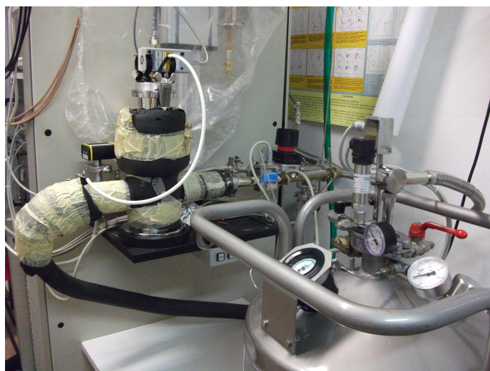
Figura 3.23: Fotografia dell'apparato di termostatazione: in basso a destra è visibile il dewar contenente l'azoto liquido e i relativi sensori, in primo piano è visibile la camera termostata e la parte superiore della cella per le misure con la sonda coassiale (è visibile l'ECal collegato tramite il cavo coassiale al network analyzer fuori campo).
