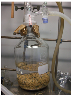
Figura 4.1: Fotografia della bottiglia predisposta per contenere solventi anidri: sulla sommità presenta un rubinetto ed un collo. Questi sono necessari per poter collegare la linea vuoto-azoto alla bottiglia e per posizionare un setto in gomma, necessari per eseguire l'operazione di canulazione quando si voglia estrarre il contenuto della bottiglia. Sul fondo sono visibili i setacci molecolari 4A.
