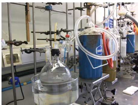
Figura 4.9: Fotografia del processo di essiccazione del \delta -[MgCl 2 ] n : dal pallone sono stati rimossi il gocciolatore ed il ricadere, si fa evaporare il solvente facendo il vuoto all'interno del pallone e lo si fa condensare all'interno di due trappole immerse in azoto liquido visibili sulla destra. Il pallone è immerso in un bagno d'acqua per evitare che la temperatura scenda troppo.
