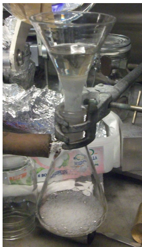
Figura 4.12: Filtrazione in atmosfera inerte della soluzione satura di PEG400 e \delta -[MgCl 2 ] n : si utilizza un imbuto a setto poroso ed una beuta codata. All'interno della beuta viene fatto il vuoto per consentire la filtrazione del composto che si presenta molto denso e viscoso.
