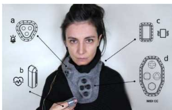
Figura 2.3: Interfaccia indossata dall'artista vista di fronte e dell'elemento al dito: a) Custodia a LED; b) Elemento al dito; c) Motore di vibrazioni; d) Manopole
