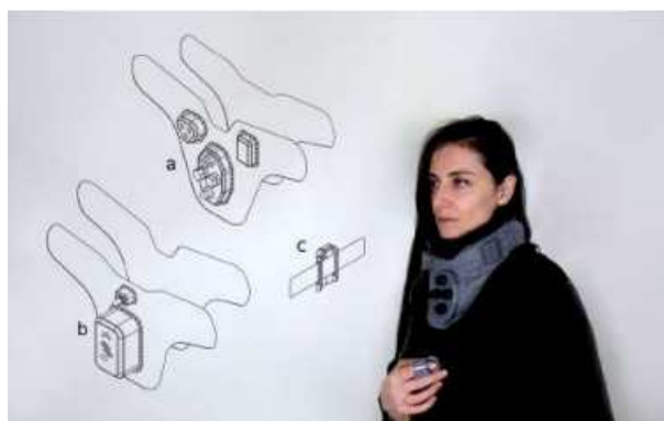
Figura 2.2: Panoramica dell'interfaccia indossata dall'artista: a) Assonometria del dispositivo di fronte; b) Assonometria del retro del dispositivo; c) Assonometria dell'elemento al dito
