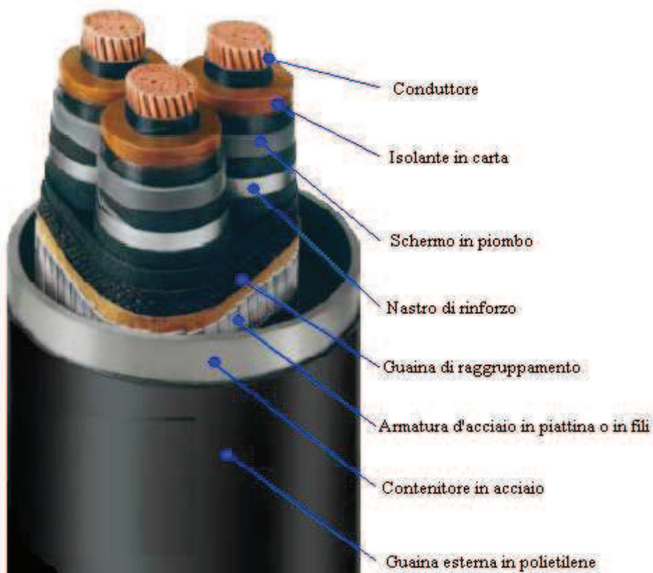
Figura 4.4 – Cavo a pressione di gas esterna
