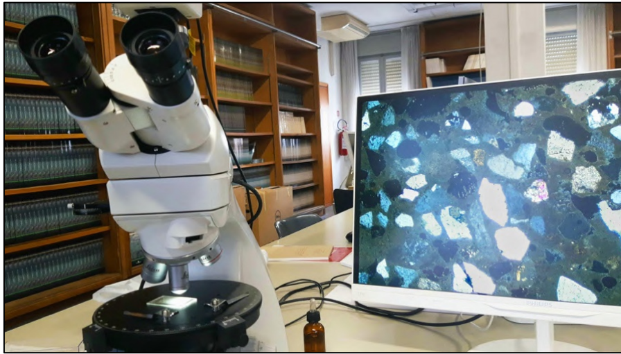
Fig. 4.2.1. Analisi di una sezione sottile al microscopio ottico Leica DM750 P.
