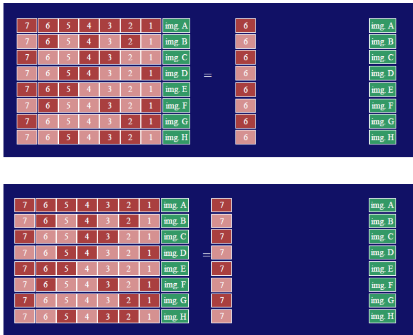
FIG. 2.3. Valutazione del sub-bolo #7 (Hadamard N=8 ) e applicazione dello schema di decoding a tutti i blocchi componenti la matrice di Hadamard.
