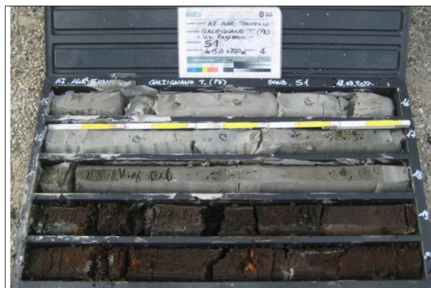
Sondaggio Geognostico S1 - Contenuto cassetta catalogatrice (15,00 – 20,00 m)
