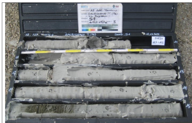
Sondaggio Geognostico S1 - Contenuto cassetta catalogatrice (10,00 – 15,00 m)
