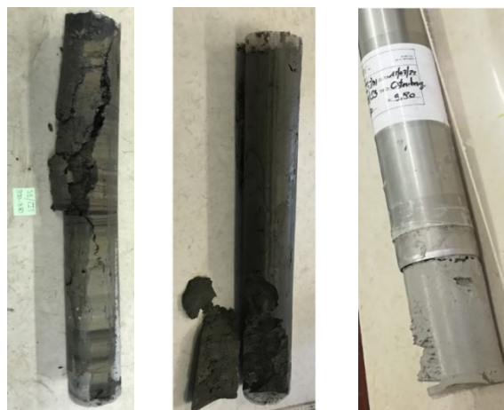
Figura 31: In ordine, provini posti a 3.20 m - 3.80 m, 6.20 m - 6.80 m, 9.20 m - 9.80 m di profondità e sottoposti ad analisi geotecniche;
