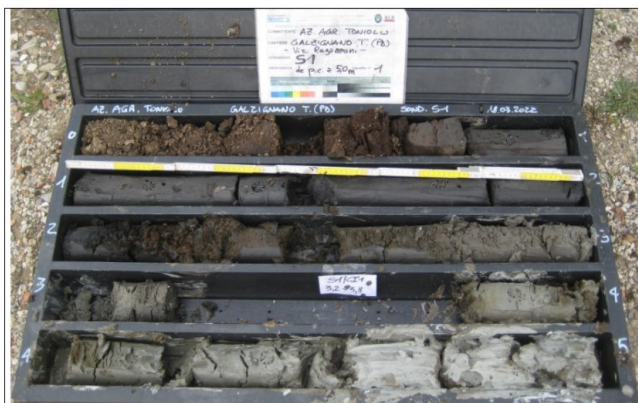
Sondaggio Geognostico S1 - Contenuto cassetta catalogatrice (0,00 – 5,00 m)
