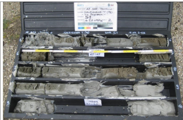
Sondaggio Geognostico S1 - Contenuto cassetta catalogatrice (5,00 – 10,00 m)
