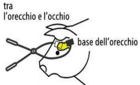
Fig4: posizionamento della pinza con elettrodi per stordimento del suino
