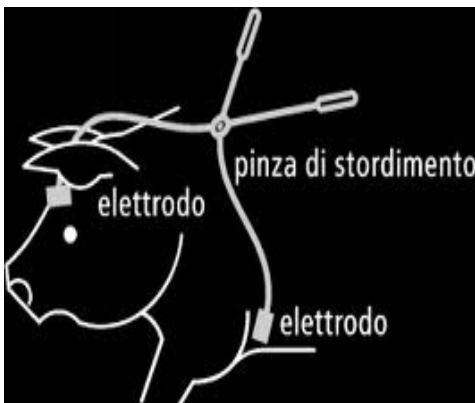
Fig4: posizionamento della pinza con elettrodi per stordimento del suino
