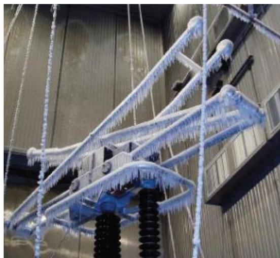
**Figura 30: Prova di tenuta atmosferica del pantografo**
