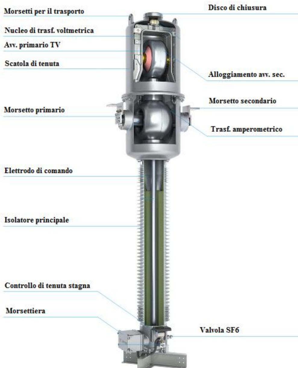
Figura 41: Immagine dell'interno del trasformatore combinato di tensione e corrente
