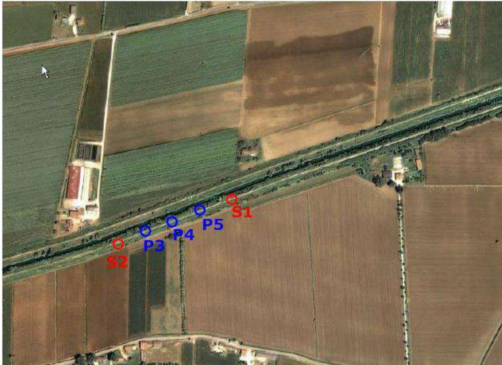
Figura 3.7: collocazione dei sondaggi e dei piezometri
