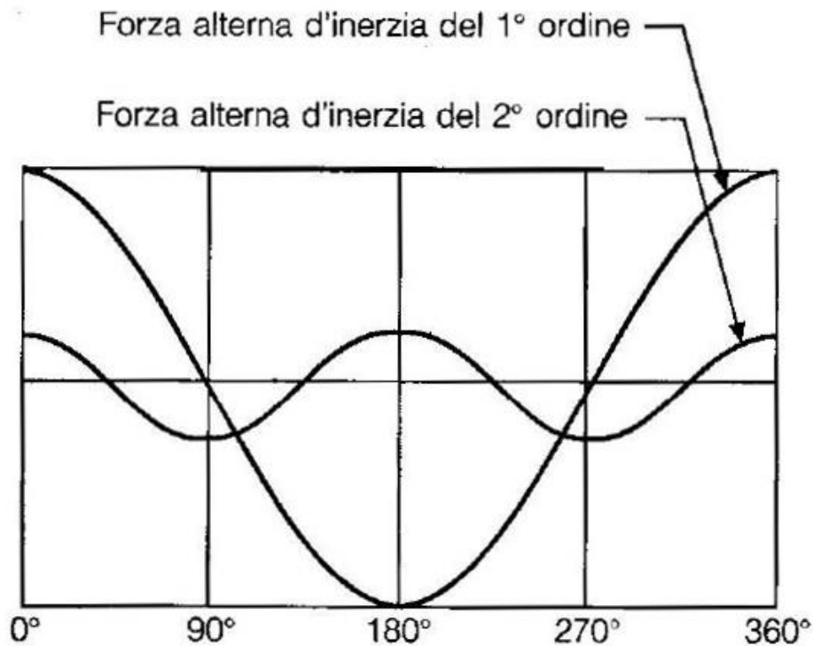
Figura 2.8 - Forze alterne del 1° e 2° ordine in funzione dell'angolo di manovella [5]
