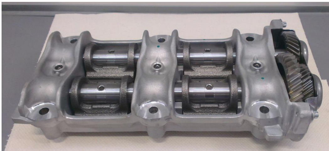
Figura 3.20 - Applicazione masse controrotanti motore R754IE4 vista dall'alto
