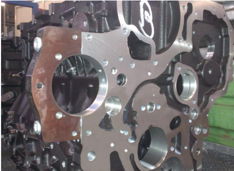
Figura 3.8 – Basamento motore R753IE4 con cappellotto per PDF montato e sede circolare lavorata di barenatura
