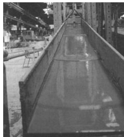
Figura 2-3: a sinistra: idrogramma relativo a una colata detritica avvenuta nel letto del torrente Name in Giappone (modificato da Takahashi, 1991; a destra: roll waves in una canaletta su cui scorre senza alcun segno visibile di turbolenza una miscela di acqua e caolinite (da Coussot, 1997).
