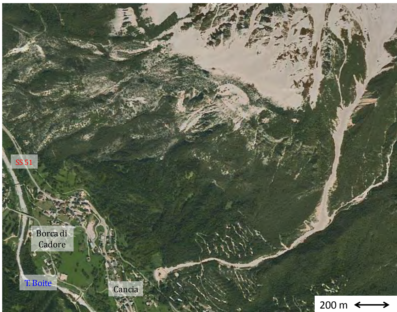
Figura 6-4: immagine satellitare dell'area di studio; è facilmente riconoscibile il percorso seguito dalle colate (noto anche come "rovina di Cancia"), mentre più a sinistra si trova una vasca di ritenuta con forma circolare (da Google Maps).
