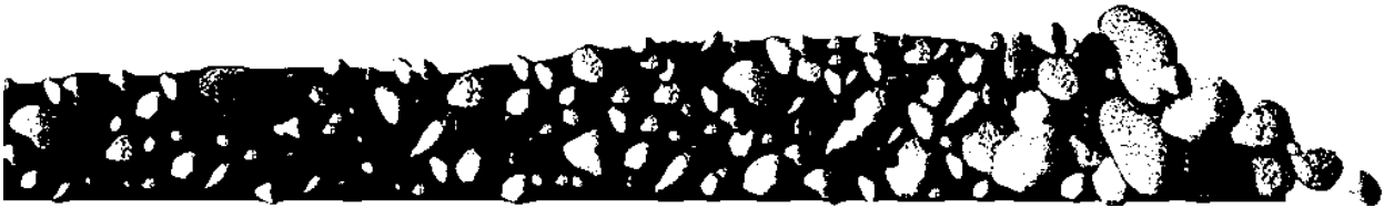
Figura 2-4: profilo longitudinale di una tipica colata di detriti; nel fronte (a destra) si distingue spesso la presenza di massi più grandi e maggiori tiranti rispetto al corpo della colata, quasi come se il fronte contenesse la parte retrostante.
