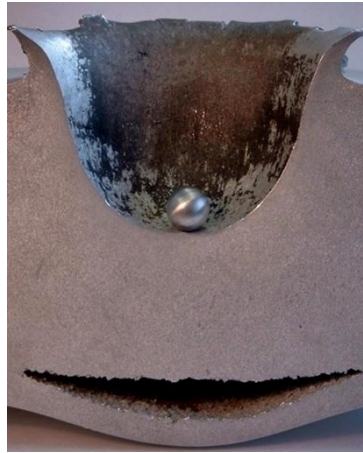
Fig. 1 Effetto dovuto ad un impatto iperveloce su una piastra bersaglio
